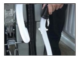
1. UNCLIP THE EMPTYING HOSE ON THE BACK OF THE BOTTOM TANK.
