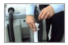
1. UNCLIP THE EMPTYING HOSE ON THE BACK OF THE TOP TANK.
